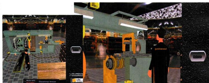
Le simulateur de cette machine spéciale permet de former les opérateurs sans bloquer la production.
