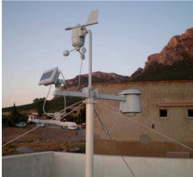
Figure VI.8 : Photo des capteurs de vent et de température de la station météorologique installée sur la terrasse de la maison considérée comme point de mesure et prélèvement
