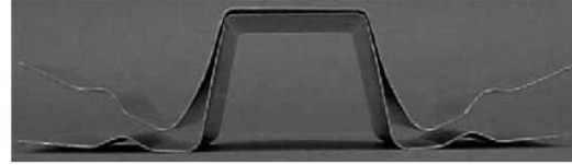
FIGURE 2.7 – Springback d'un « U-bending ».
