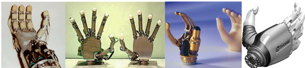
Figure 0-5. Exemples de mains artificielles dédiées à la recherche (a et b) ou la prothétique (c et d). a) LMS Hand (Gazeau, et al. 2002) b) GIFU Hand III (Tetsuya, et al. 2002) ; c) Otto Bock Sensorhand Speed (OttoBock, SensorHand Speed datasheet 2012) ; d) the BeBionic myoelectric hand (BeBionic 2012).
