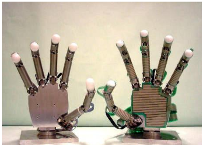
Figure II-6. La Gifu Hand III nue (modèle de gauche) et couverte par son réseau de capteurs de contact (modèle de droite) (Tetsuya, et al. 2002).
