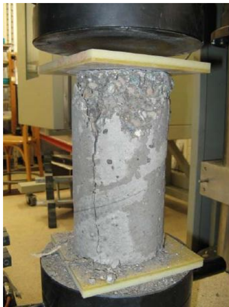
Figure 3.5 Essais de résistance mécanique en compression sur une éprouvette de béton [CSTB, 2010].
