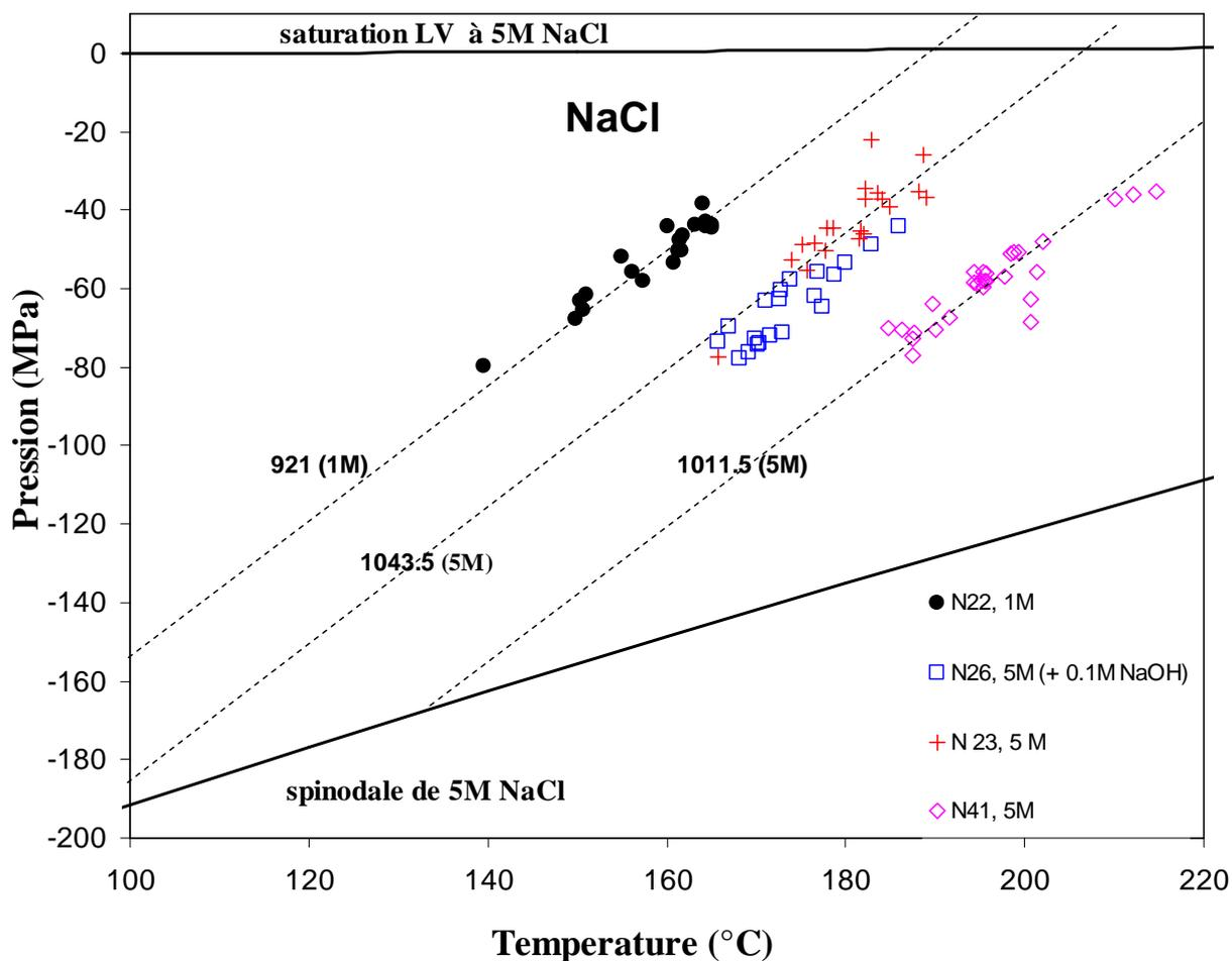
Figure 35 : Coordonnées P-T des solutions à  $H_2O + 1M$  et  $+5M NaCl$  dans 88 inclusions fluides, à partir des mesures microthermométriques. Les isochores sont libellées avec les densités de liquide en  $kg.m^{-3}$ . La spinodale thermodynamique de  $H_2O + 5M NaCl$  a été calculée à partir de l'EOS de [Anderko et Pitzer \(1993\)](#).
