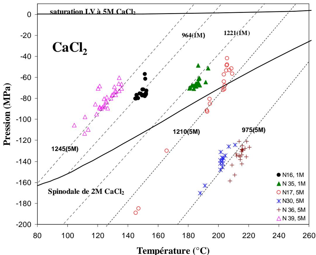
Figure 36: Tension dans des solutions à 1M et 5M CaCl<sub>2</sub> dans 128 inclusions fluides, à partir des mesures microthermométriques. Les isochores sont libellées avec les densités de liquide en kg.m<sup>-3</sup>.
