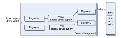
Figure 3: Diagramme simple de la gestion de l'alimentation dans le CPS.
