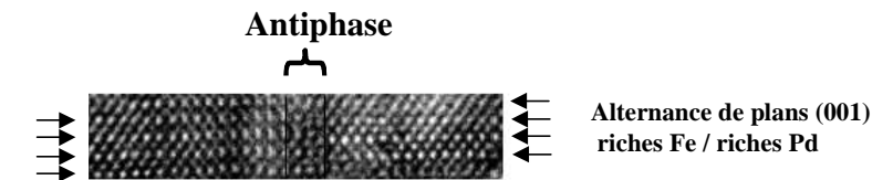
Figure 3.1: section transverse d'une couche de FePd déposée à 300°C. (axe de zone [1-10]). L'ordre L1_0 selon [001] se traduit par une alternance du contraste entre plans (001) successifs.
