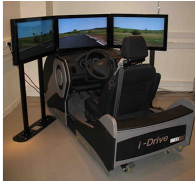
Figure 2.1: Simulateur de conduite du laboratoire IRCCyN. L'environnement visuel est affiché sur trois écrans LCD de 32 pouces d'une résolution de 1280 x 720 pixels. Les écrans latéraux sont inclinés de 45° par rapport à l'écran central. L'ensemble offre un champ de vision horizontal de 115° à une distance de 1 mètre.
