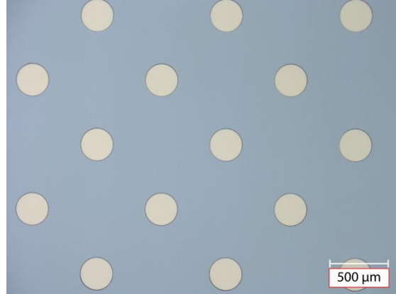
Figure 3.52 : Inspection aux microscopes optique et électronique des matrices de ronds en nickel transférées sur un substrat de 100 mm
