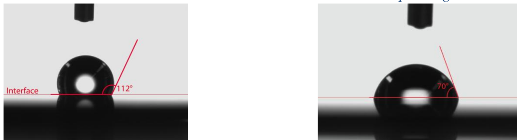
Figure 3.36 : Images de mesures d'angle de contact à l'aide d'une goutte d'eau distillée
