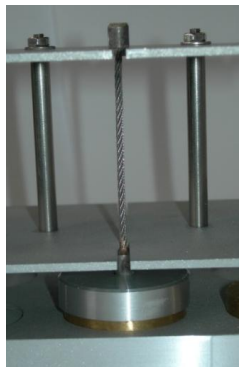
Figure 3.40 : Vue de profil du système guidé employé pour le collage du câble de traction et de l'échantillon
