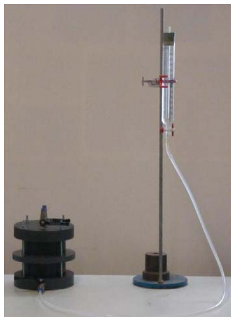
Figure 19 : Montage du dispositif de mesure de la perméabilité des matériaux de filtration
