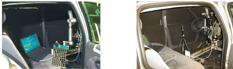
(a) Grille de microphones utilisée. (b) Système de déplacement utilisé
