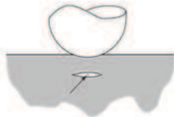
Figure I-4 : Illustration de l'usure par fatigue. [15]
