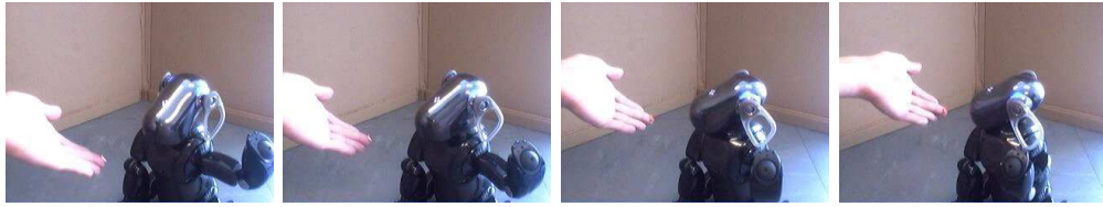
FIG. 2.22: En jouant sur l'ambiguïté de la perception, le robot voit la main de l'humain comme si c'était sa patte. Le robot agissant comme un homéostat, il cherche alors à corriger l'erreur entre la position de ce qu'il voit et la position fournie à partir de ces informations motrices. Alors on observe que le robot imite le geste de l'humain avec sa patte.
