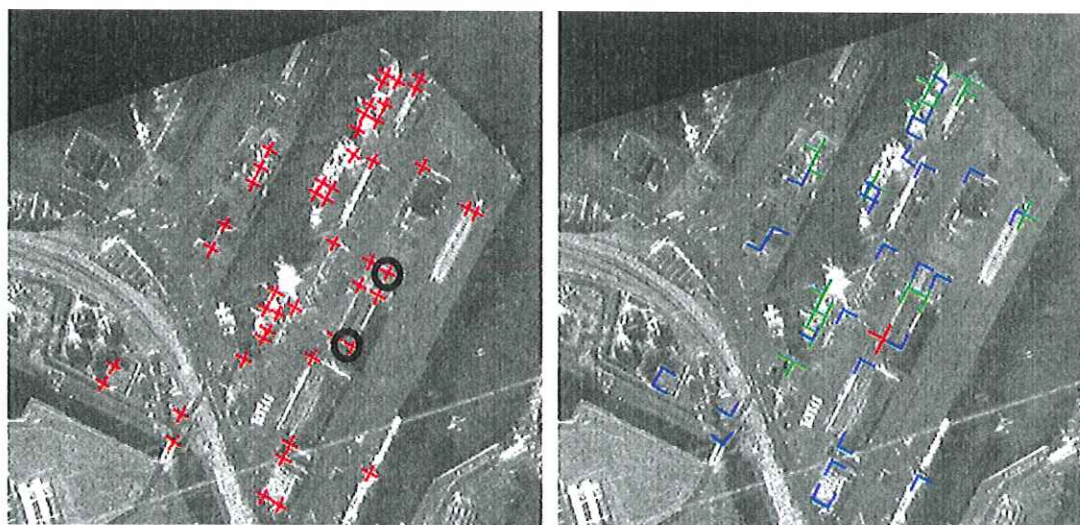
figure 3-33 : TH locale modifiée sur une image en bande X, croix et décision croix/T/coins. Longueur=20. Les cercles noirs indiquent des croix entre l'écho double et l'écho du bord du toit
