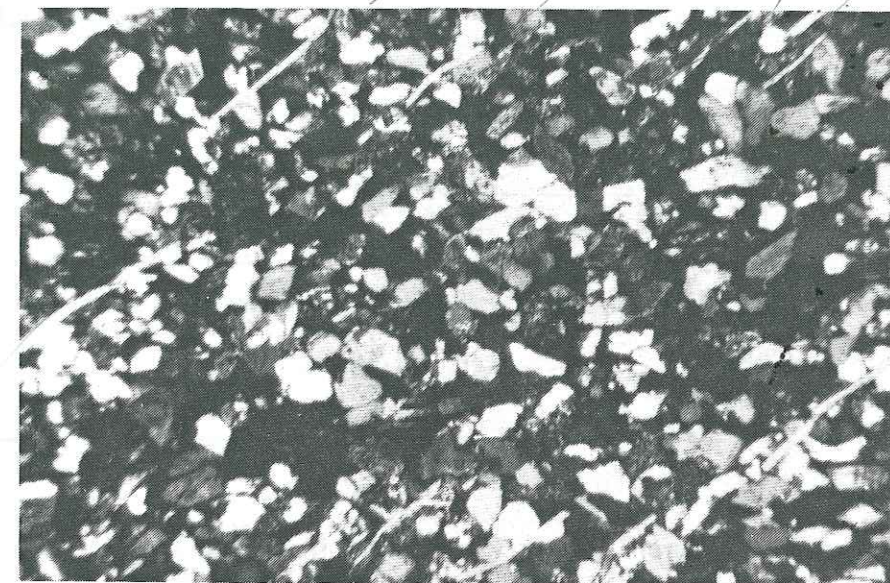
Photographie II.1 - Observation d'une lame mince sous microscope à transmission (lumière polarisée) ; grossissement x30.
