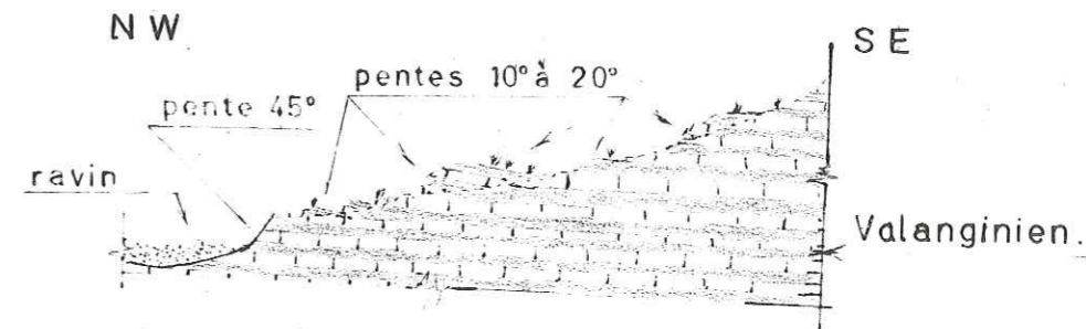
Fig. 25. - Glissement de reptation à "Combe du Guers"
