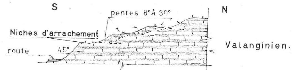
Fig. 26. - Glissement de reptation à "Louriou"
