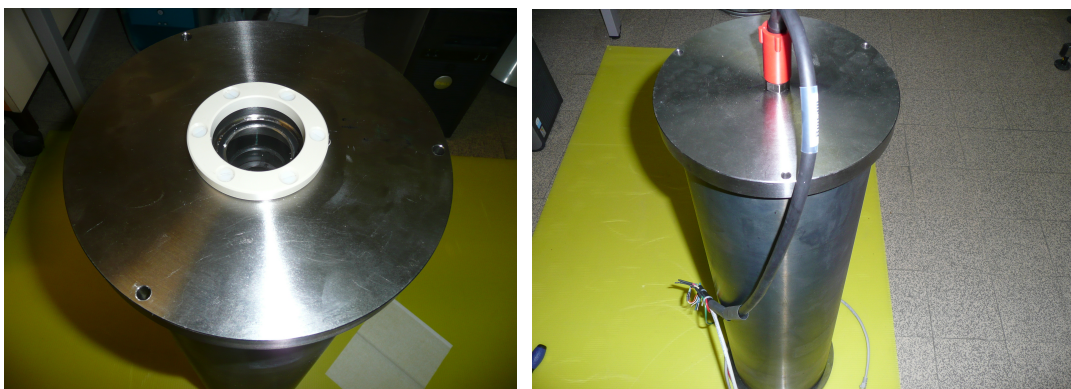
FIGURE II.26 – Photographies de l’avant et de l’arrière de la caméra montée dans son tube en titane de 50 cm de long. On voit le hublot qui permet l’observation avec un objectif classique de caméra. On voit également le seul câble sortant de la caméra qui délivre le courant et le câble Ethernet 100 Mbits/s.
