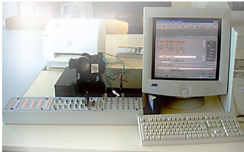
Figure 5.4.5 – Banc d'essai du papillon motorisé
