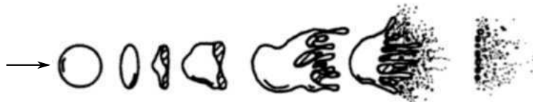
FIGURE 1.6 – Régime d'atomisation secondaire stripping breakup.
