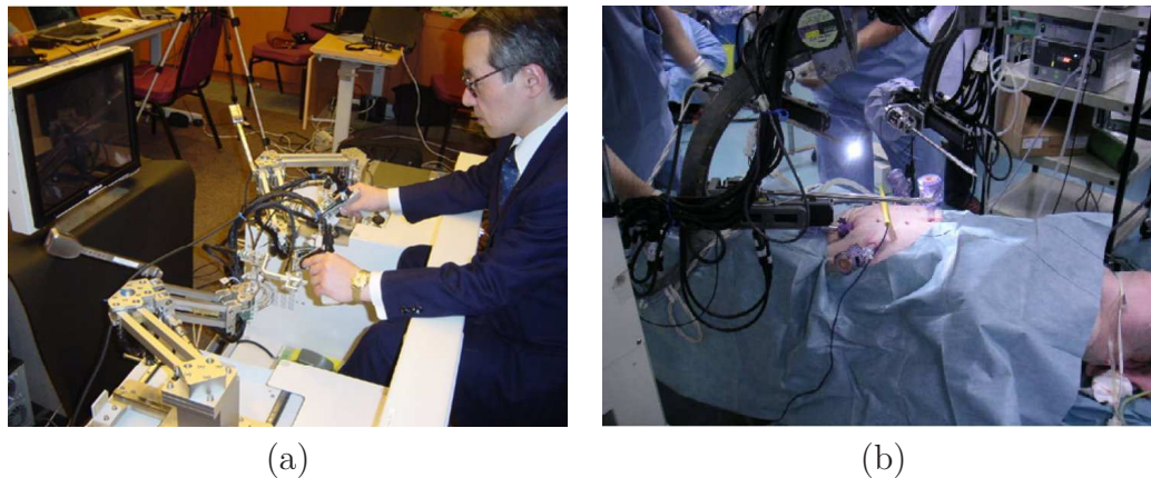
FIGURE 1.14 – Téléopération à distance : (a) site maître en Corée du Sud; (b) site esclave au Japon.
