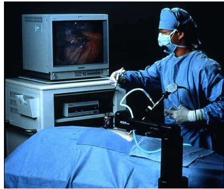
FIGURE 1.6 – Le robot AESOP destiné à manipuler l'endoscope à la place du chirurgien.
