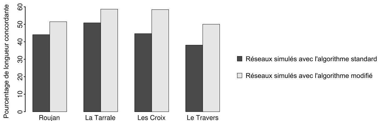
Figure 5.8 – Pourcentage de longueur concordante avec le vrai réseau pour des réseaux simulés de même longueur que le vrai réseau, selon la version de l’algorithme, pour les quatre sous-bassins versant tests. Les pourcentages correspondent à des valeurs ajustées par polynômes locaux pour des réseaux de même longueur que les vrais réseaux.
