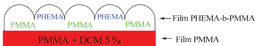
Schéma V-28 : Organisation micellaire du copolymère bloc PHEMA-b-PMMA sur le film du polymère PMMA dopé avec 5 % de DCM.
