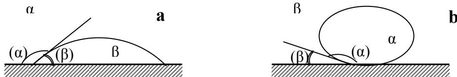
Figure III.15. Mesure directe de l'angle ( \beta ) dans le cas d'un produit coulant (a) et par l'intermédiaire de l'angle ( \alpha ) dans l'expérience possible pour un produit flottant (b).
