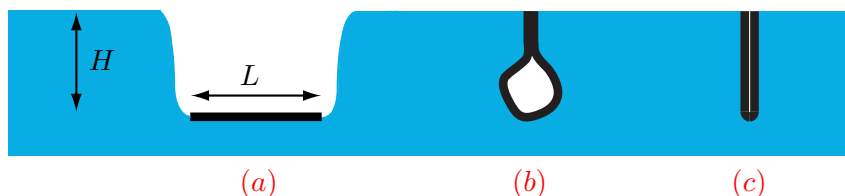
FIGURE 4.1: Un lamelle élastique, de longueur L , est plongée dans un liquide à un niveau H . Trois cas de figure sont illustrés : (a) la lamelle est complètement rigide et ne se déforme pas. (b) la lamelle se déforme avec une courbure répartie de manière quasi uniforme. (c) la lamelle se déforme avec une courbure concentrée en un point.
