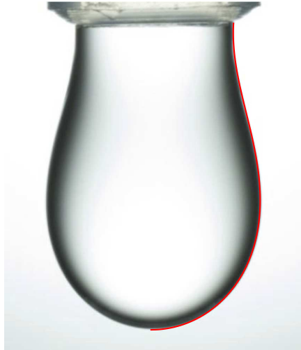
FIGURE A.2: Comparaison entre la forme expérimentale et la solution numérique (rouge) pour un profil de goutte pendante. Parmi la famille de solutions, paramétrées par le nombre de Bond, la solution qui superpose exactement le profil expérimental est repérée par Bo = 0.31 .
