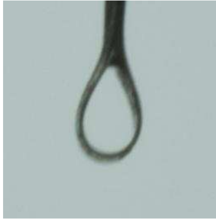
FIGURE A.4: Photo de la lamelle de PDMS repliée en boucle, avec le ménisque d'éthanol. L'ouverture maximale est \delta .
