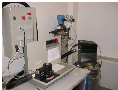
Figure 3.4. DSC de type TA-2920 refroidie à l'azote liquide, utilisée pour les deux matériaux.
