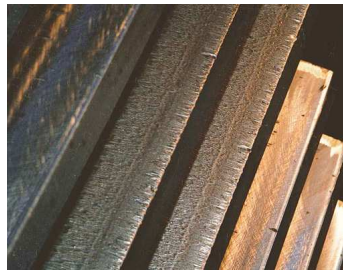
Figure I-6 : Grippage couvrant l'ensemble des dentures [31]
