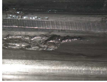
Figure I-7 : Ecaillage par fatigue [31]
