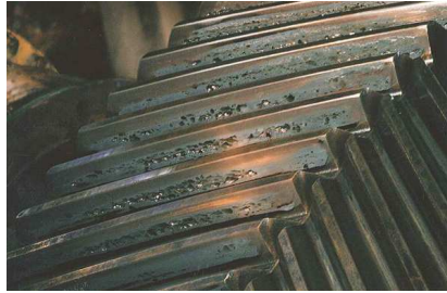
Figure I-5 : Pittings évolutifs sur une roue chevron [31]
