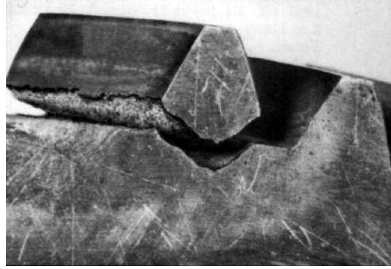
Figure I-9 : Dent cassée due à aux fissures en pied de dent résultant de la fatigue liée aux charges cycliques de flexion
