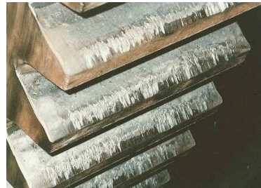
Figure I-10 : Grippage localisé sur les têtes de dent [31]
