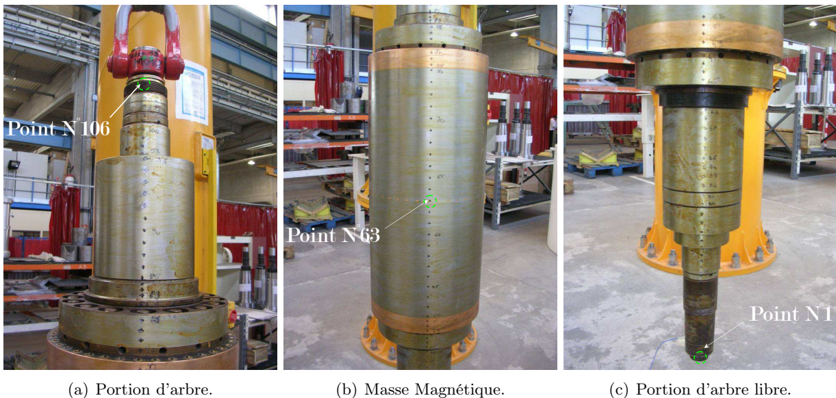
FIGURE 3.9 – Dispositif de suspension et maillage expérimental.
