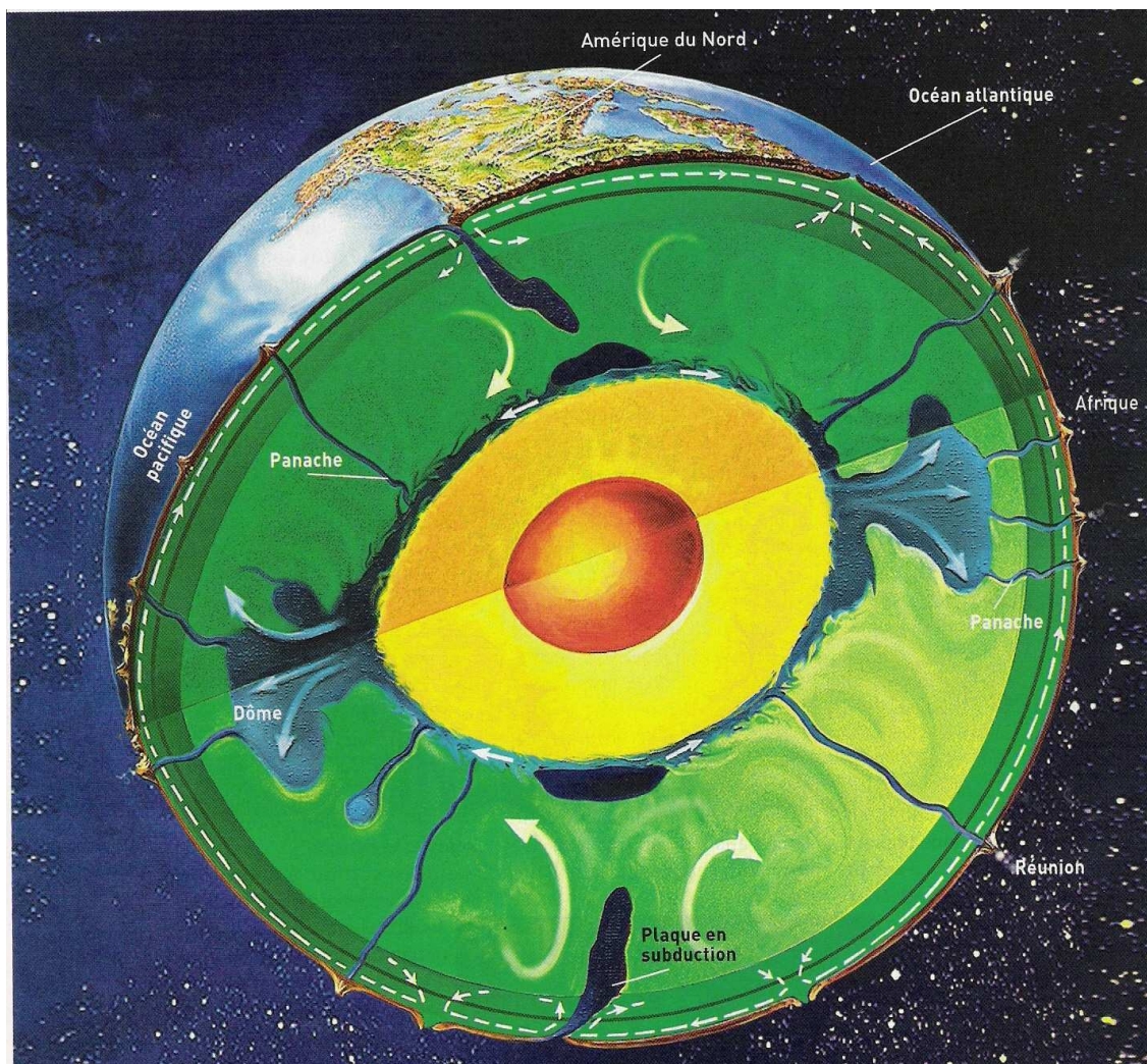
Figure 3.15 Vision schématique d'une convection en dômes.
