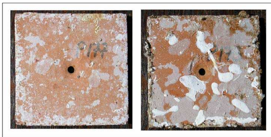
Figure 98 : photographie du dessous d'une plaque ayant été immergée 3 mois puis retournée une semaine (à gauche) et du dessous d'une plaque immergée en même temps et à la même station que la première, mais n'ayant pas été retournée (à droite). Les deux plaques ont été blanchies à l'eau de Javel avant d'être photographiées.
