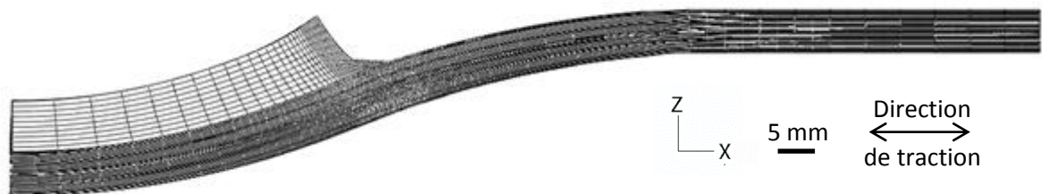
Figure 3-16 : Déformée (x100) d'une éprouvette représentative dont la partie polymère et la partie composite ont été collées.
