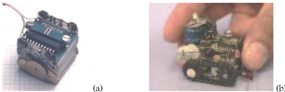
Figure 1.21. : Microrobots à roues Jemmy (a) [NICO-97] et à chenilles The Ant (b) (MIT)
