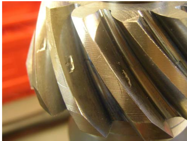
Figure 3.43 : Endommagement dans les flancs convexes du pignon
