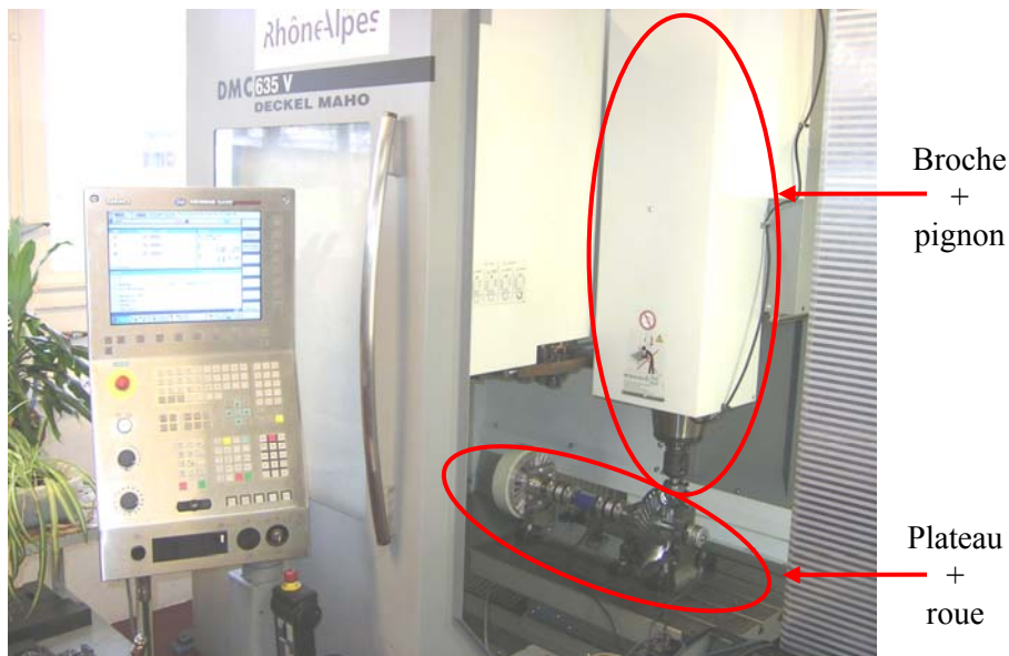
Figure 3.18 : Présentation du banc de la fraiseuse
