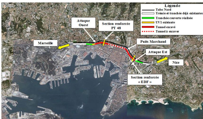
Figure 3.1 Implantation du Tube Sud et différentes attaques
