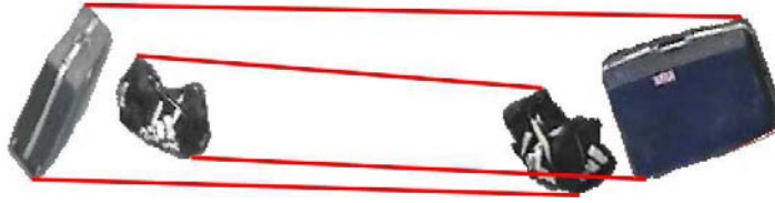
FIGURE 2.23 – Illustration d'un cycle ayant quatre arcs d'association. Pour éviter ce type de situation le nombre d'arc d'association est limité à 2 par cycle.
