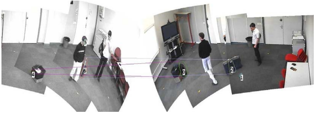
FIGURE 3.8 – Le sac (silhouettes 0 et 4) est fortement occulté par une poubelle dans l’une des caméra, mais les silhouettes sont correctement appariées.
