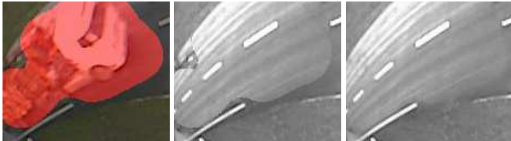
FIGURE 1.7 – Influence du lissage spatial sur le modèle de fond. Gauche : segmentation fond/premier plan. Milieu : mise à jour du fond sans lissage. Un saut de luminosité apparaît à la frontière de la zone mise à jour et modifie la texture de l’image. Droite : mise à jour du fond avec lissage. La texture originale est conservée.
