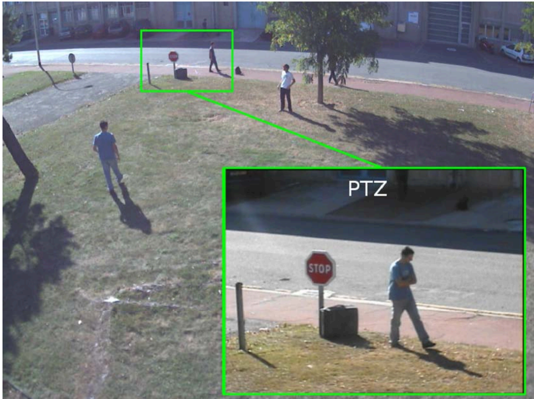
FIGURE 2 – Les caméras PTZ permettent de se focaliser sur une partie de la scène à une résolution adaptée. En contrepartie seulement une partie restreinte de la zone est visible.
