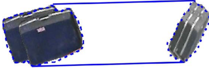
FIGURE 3.6 – La fusion intra-caméra des silhouettes provenant de vues différentes permet de garantir l'unicité de la détection d'un objet. Pour une meilleure compréhension, les silhouettes de la valise détectée sur les deux vues sont volontairement décalées.
