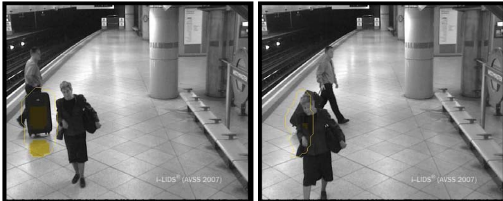
FIGURE 1.20 – Séquence AVSS AB Easy. Fausses alarmes : persistance de la détection suite à la mise en mouvement d'un objet stationnaire et à une occultation. Bien que l'objet ne soit plus stationnaire l'alarme est toujours levée car le fond n'a pas été re-observé.
