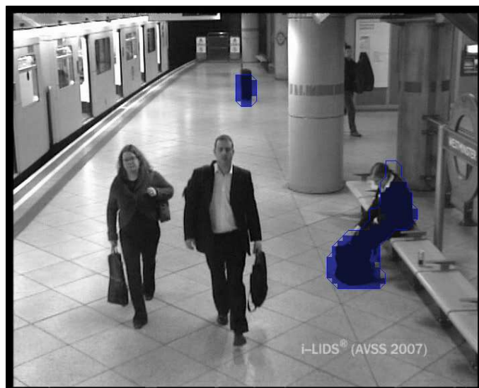
FIGURE 1.19 – Séquence AVSSAB Hard. Cas où la détermination du nombre de vraies et fausses alarmes reste subjective. Le blob contenant la personne assise peut être considéré comme vrai positif puisqu'il englobe un objet stationnaire (le bagage à ses pieds). Il peut aussi être considéré comme un faux positif car la personne bien que bougeant peu n'est pas exactement stationnaire. Dans ce dernier cas la surface détectée est beaucoup plus importante que la surface du bagage seulement.
