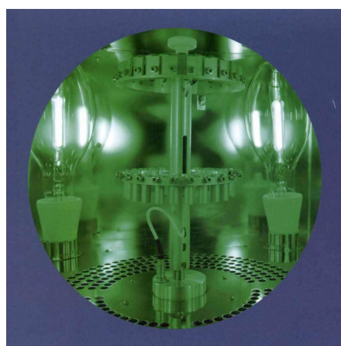
Figure II 1. (Gauche) Chambre d'irradiation d'une enceinte SEPAP 12-24 (Droite) Spectre d'émission des lampes Novalamp RVC 400W.
