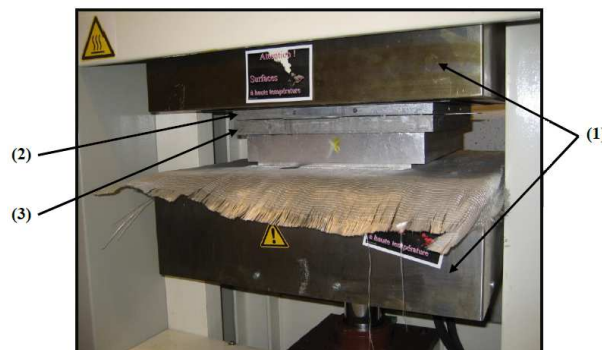
FIG. 2.7 – Installation du moule dans la presse chauffante. (1) plaques chauffantes de la presse, (2) contre-moule, (3) moule
