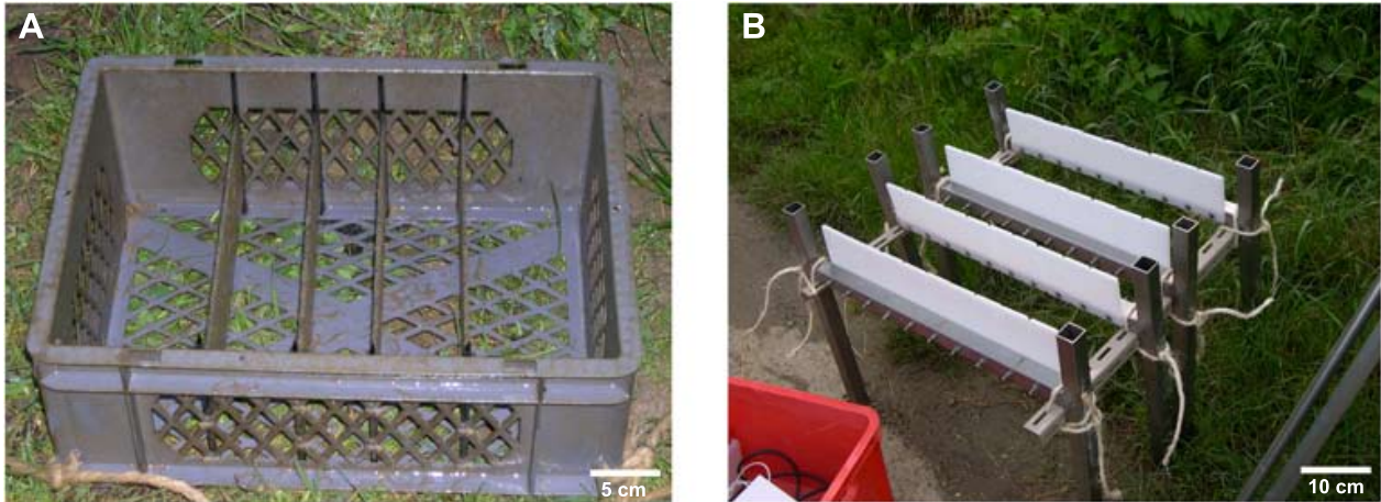
Figure 26 – Dispositifs de production et de collecte de biofilms phototrophes in situ : (A) avec les lames de verre disposées à raison de 4 par cagette (1 lame = 1 réplikat) et (B) avec les plaques en polyéthylène disposées à raison de 40 sur support métallique (1 plaque = 1 réplikat)
