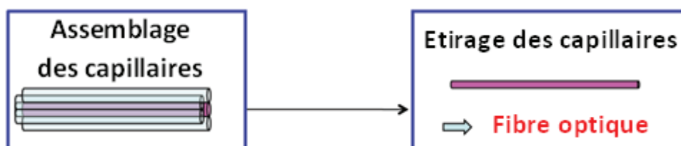
Figure 22 : Les différentes étapes de la formation d'une fibre optique créée par voie sol-gel à partir d'un monolithe de silice poreux.
