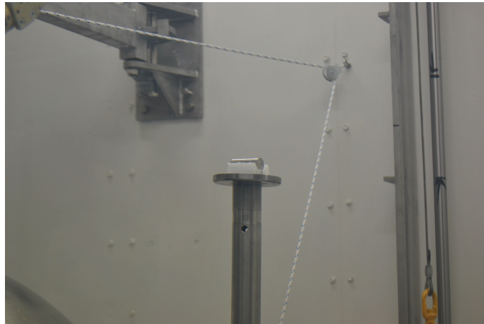
Figure 5.3.: Photographie de l'ensemble de mesure de l'anisotropie par la méthode du cône d'ombre
