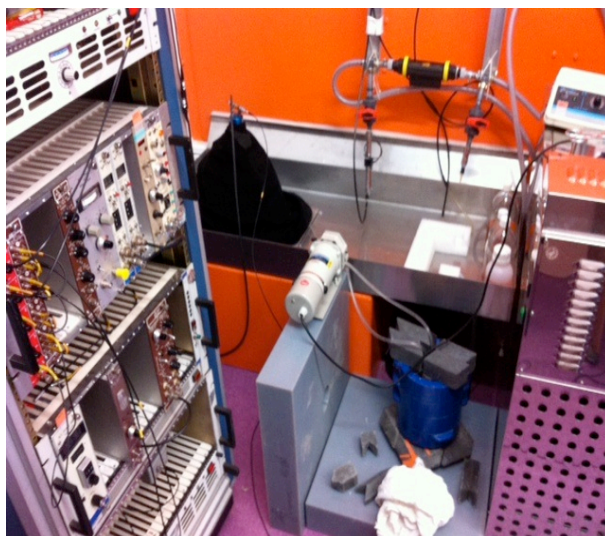
Figure 5.9.: Installation utilisée lors de l'exercice ^{56}\text{Mn} pour la mesure par coïncidences Cerenkov-gamma en ligne
