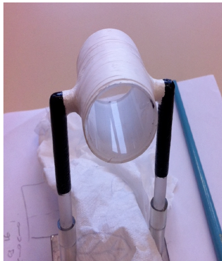
Figure 4.19.: Photo de la cellule en quartz du détecteur Cerenkov-gamma
