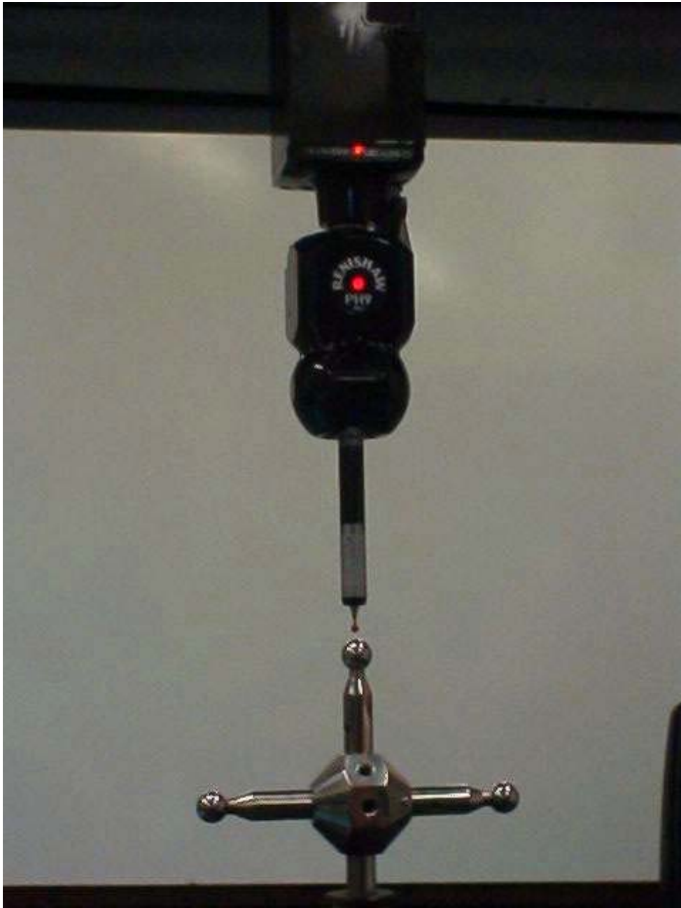
photo n°3 2 approche du capteur sur les sphères de mesures
