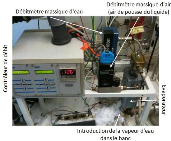
Figure 46: Système de génération de vapeur d'eau dans le "Banc Gaz Chauds EMSE"
