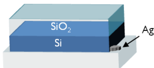
Figure 3 : Structure des substrats silicium oxydés.
