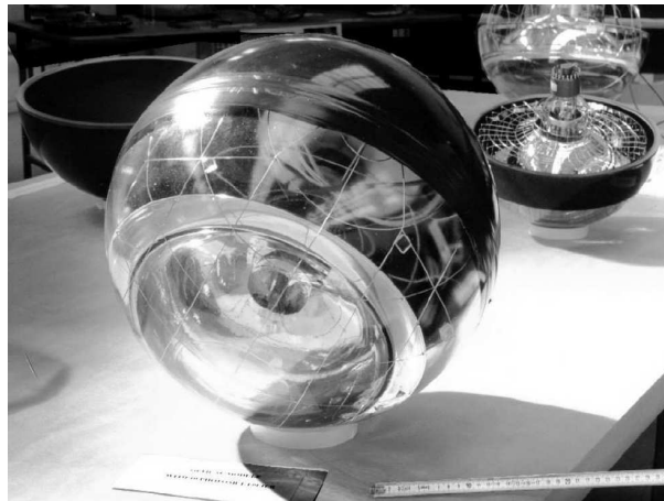
FIG. 1.13 – Une photographie d'un module optique. Le photomultiplicateur, la grille en mu-métal, ainsi que l'hémisphère peint en noir sont visibles ici.
