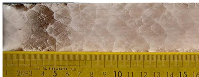
Figure II. 6 : Exemple de traces sur suie -  $\Phi=1,1$ ;  $x=0,95$ ;  $P_i=1$  bar- Tube de section droite carré
