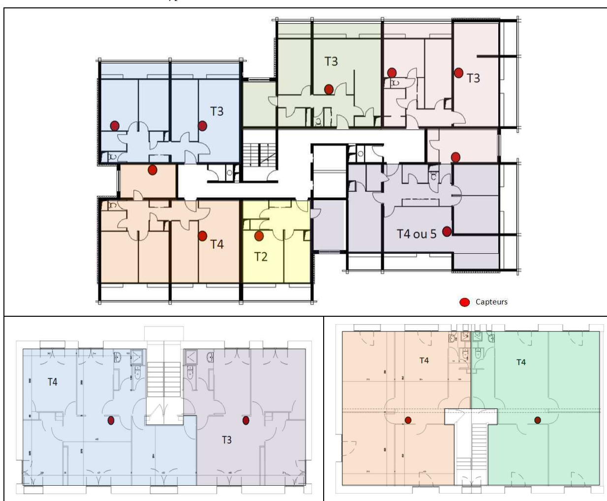
Figure 85 : Emplacement des capteurs de température et d'humidité dans les logements du Meygal (en haut), des Echos R+2 (en bas à gauche) et des Suzannes (en bas à droite).
