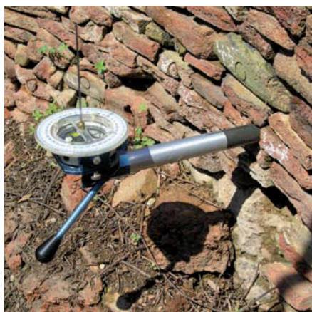
Figure 5 : Dispositif d'orientation des carottes
