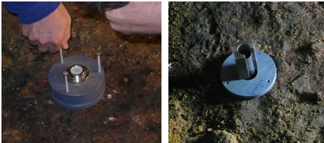
Figure 3 : Dispositif de prélèvement (clichés A. Brodard et A. Burens). A gauche, réglage de l'horizontalité des cadres pour le carottage. A droite, système d'équerre utilisé pour l'orientation des carottes dans l'espace par visée au tachéomètre.
