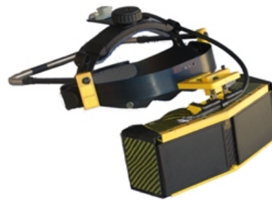
(b) Visiocasque de Fakespace (résolution de 1600 \times 1200 pixels , champ de vision de 150^\circ ).
