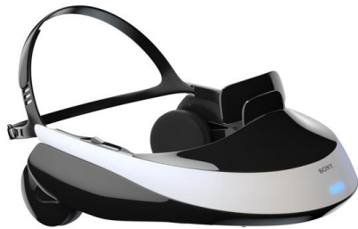
(a) Visiocasque de Sony (résolution de 1280 \times 720 pixels , champ de vision de 45^\circ ).
