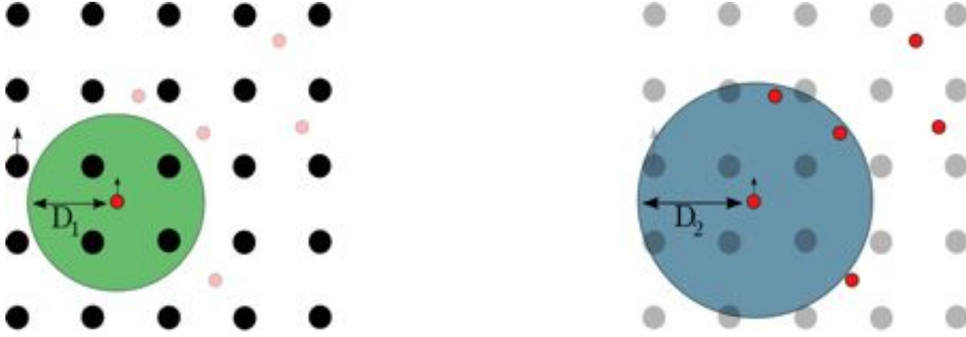
FIGURE 3.8 – A gauche : Schéma d'interaction d'un électron (en rouge) avec les ions du réseau (en noir) à l'intérieur d'une sphère de rayon D_1 centrée autour de l'électron. A droite : Schéma d'interaction d'un électron (en rouge) avec les autres électrons (en rouge) à l'intérieur d'une sphère de rayon D_2 centrée autour de l'électron.
