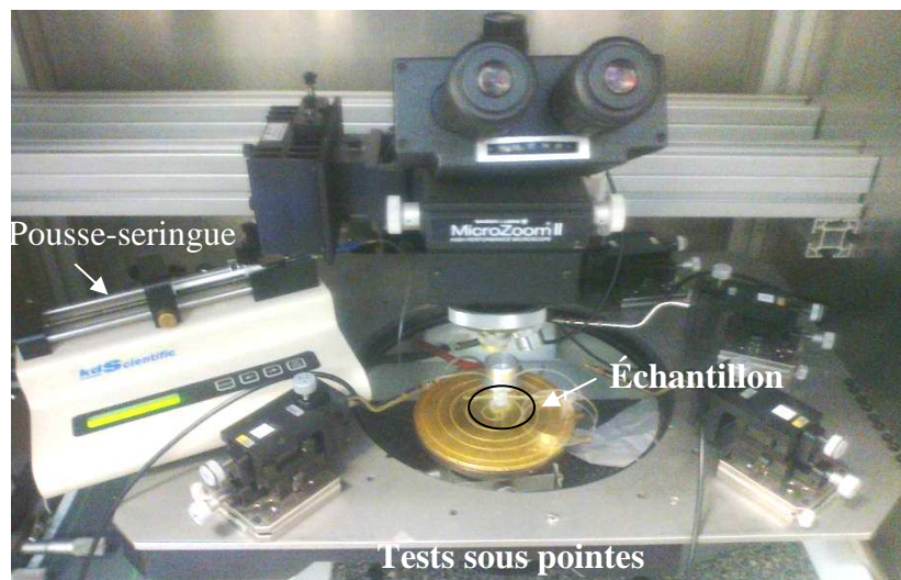
Figure 80. Schéma du montage pour les différentes caractérisations électriques
